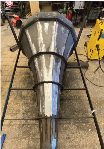
Pavillon en acier soudé (2023) L: 2m / gD: 1,2m / pD:30cm amplificateur acoustique d'une long string sur membrane (dispositif sonore en cours de réalisation)
